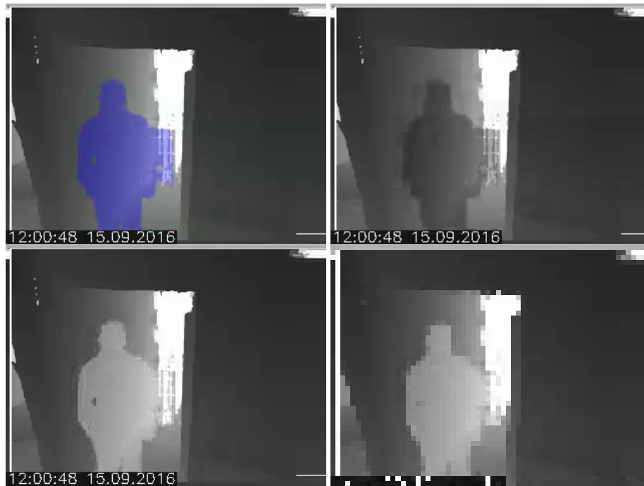
Abbildung 4.3: Es ist ein Vergleich vom Originalframe (oben links), zu einem Kanal ohne Hervorhebung (oben rechts), dem Kanal mit Hervorhebung (unten links) und einer Pixelreduktion des Kanals mit der Hervorhebung (unten rechts) zu sehen. Die Pixel wurden auf jeden 5ten reduziert.
