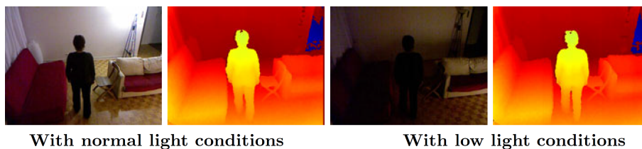
Abbildung 2.2: Unterschied zwischen einer Tiefenkarte, welche bei guten Lichtverhältnissen und einer welche bei schlechten Lichtverhältnissen erstellt wurde. [RAR + 11]
