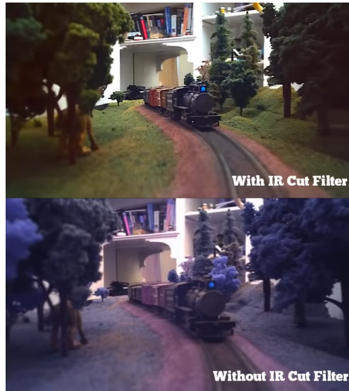
Abbildung 2.1: Unterschied zwischen der Verwendung eines IR-Cut Filters und der Bilderfassung ohne einen solchen. [Mar20]
